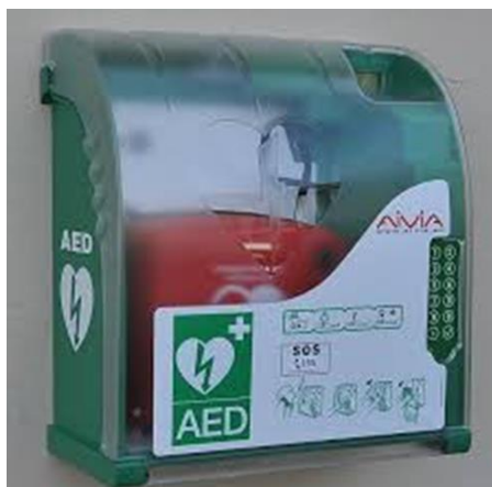
Obr. 6 Umístění defibrilátoru ve venkovním boxu, box je možné otevřít po zavolání na tísňovou linku 155, operátor sdělí kód pro otevření
